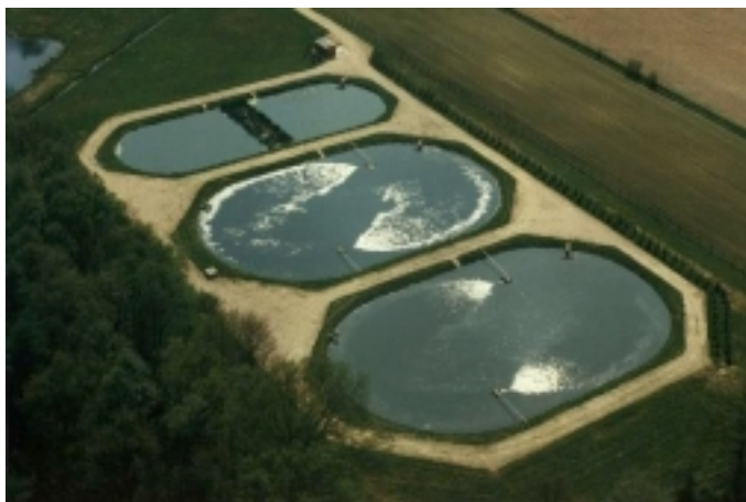
L'aérateur à vis hélicoïdale FUCHS génère un déplacement horizontal de l'eau
